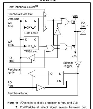
FIGURE 3-6: PORTC BLOCK DIAGRAM (PERIPHERAL OUTPUT OVERRIDE) RC<4:3>
