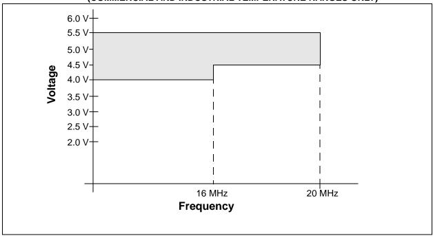
FIGURE 15-2: PIC16LF87X-04 VOLTAGE-FREQUENCY GRAPH (COMMERCIAL AND INDUSTRIAL TEMPERATURE RANGES ONLY)
