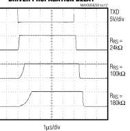
LOOPBACK PROPAGATION DELAY vs. R<sub>RS</sub>
