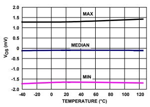
FIGURE 22.  $V_{OS}$  vs TEMPERATURE  $V_{IN}$  = 0V,  $V_+$ ,  $V_-$  = ±2.75V
