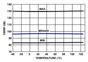
FIGURE 31. CMRR vs TEMPERATURE V<sub>CM</sub> = -2.5V TO +2.5V, V<sub>+</sub>, V<sub>-</sub> = ±2.5V
