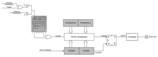
Figure 32.10. PCA 16-Bit PWM Mode
