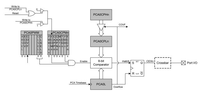
Figure 32.8. PCA 8-Bit PWM Mode Diagram
