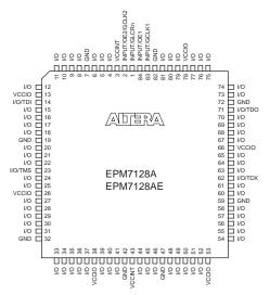
Figure 17. 100-Pin TQFP Package Pin-Out Diagram
