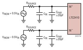
Figure 16. An RC Network at IN<sup>+</sup> and IN<sup>-</sup>
