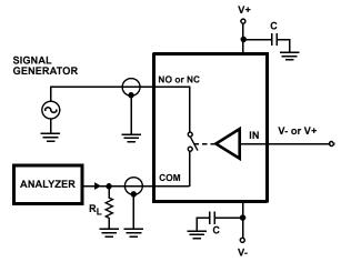
FIGURE 3. OFF-ISOLATION TEST CIRCUIT
