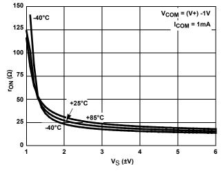
FIGURE 7. ON-RESISTANCE vs SUPPLY VOLTAGE
