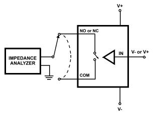
FIGURE 5. CAPACITANCE TEST CIRCUIT
