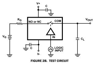
FIGURE 2. CHARGE INJECTION
