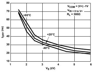
FIGURE 12. TURN-OFF TIME vs SUPPLY VOLTAGE
