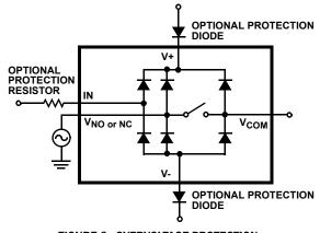
FIGURE 6. OVERVOLTAGE PROTECTION
