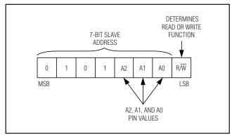
Figure 5. DS1882's Slave Address Byte
